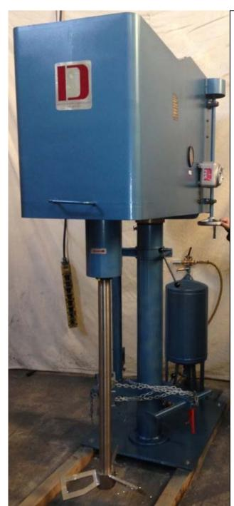
SERIES 4050 DRUM MIXER, VARIABLE LOW SPEED, HIGH TORQUE MODEL DVL-150-43/24-EX/SS
